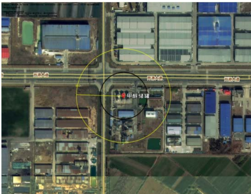
图 5.2.7-8 最不利气象条件下甲醇不完全燃烧伴生 CO 危害区域图
