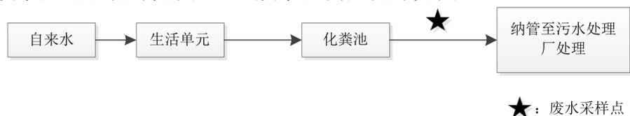
图 3-1 废水处理流程图
