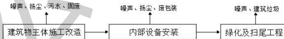
图3-1 施工期工艺流程及排污节点图
