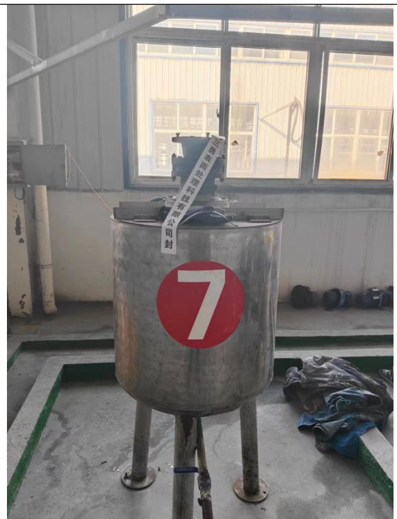
7#搅拌罐已购置不再生产，动力设备未安装
