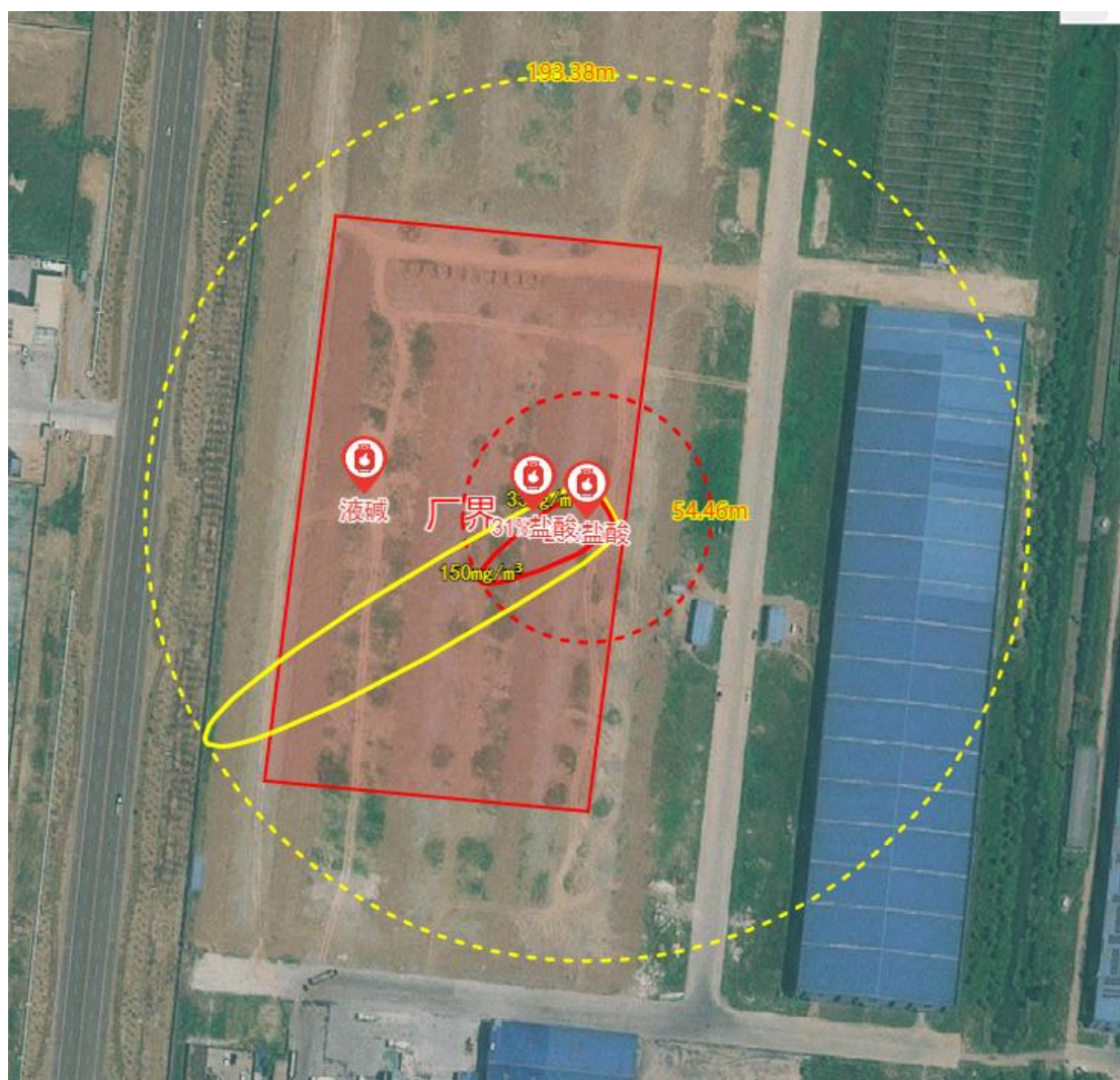
图 5.5-6 25%盐酸储罐泄漏液池蒸发扩散不同阈值的最大影响范围
