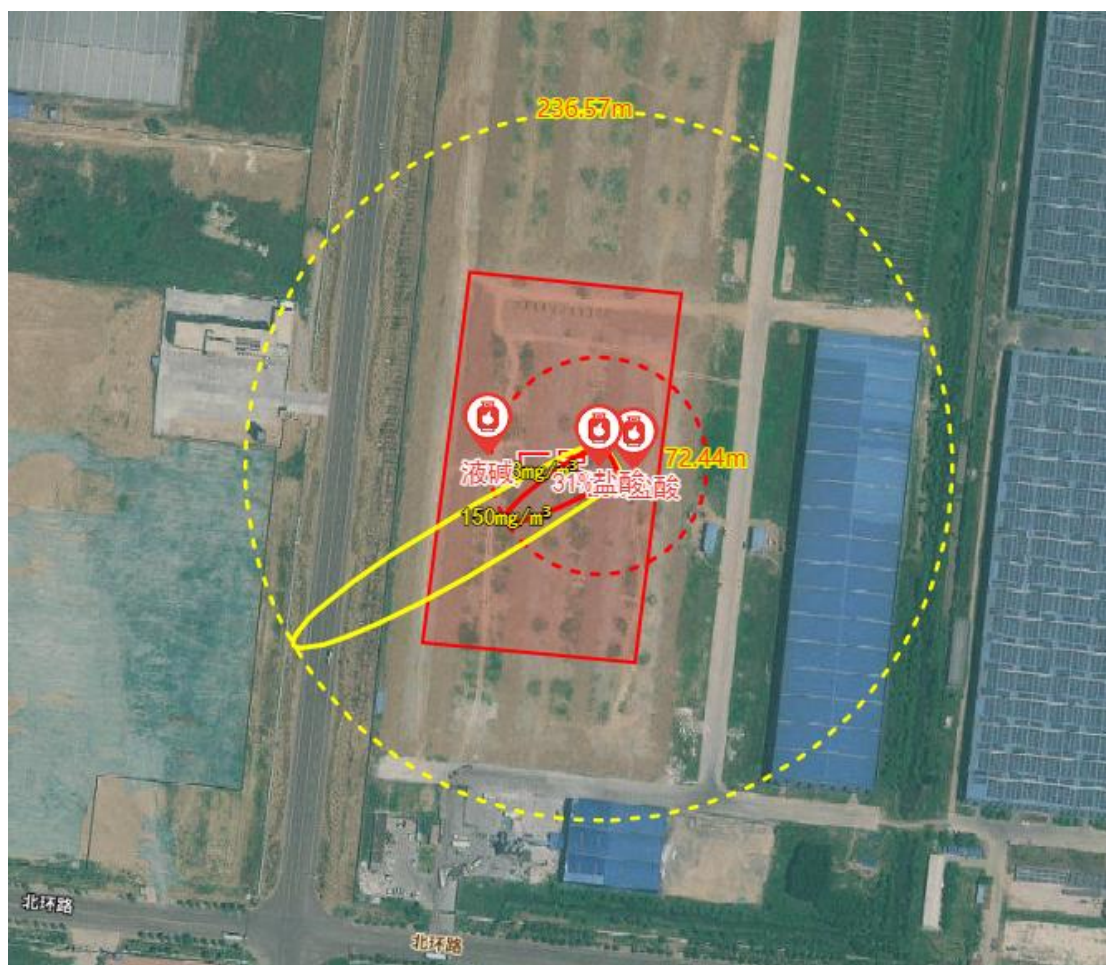
图 5.5-12 31%盐酸储罐泄漏液池蒸发扩散不同阈值的最大影响范围
