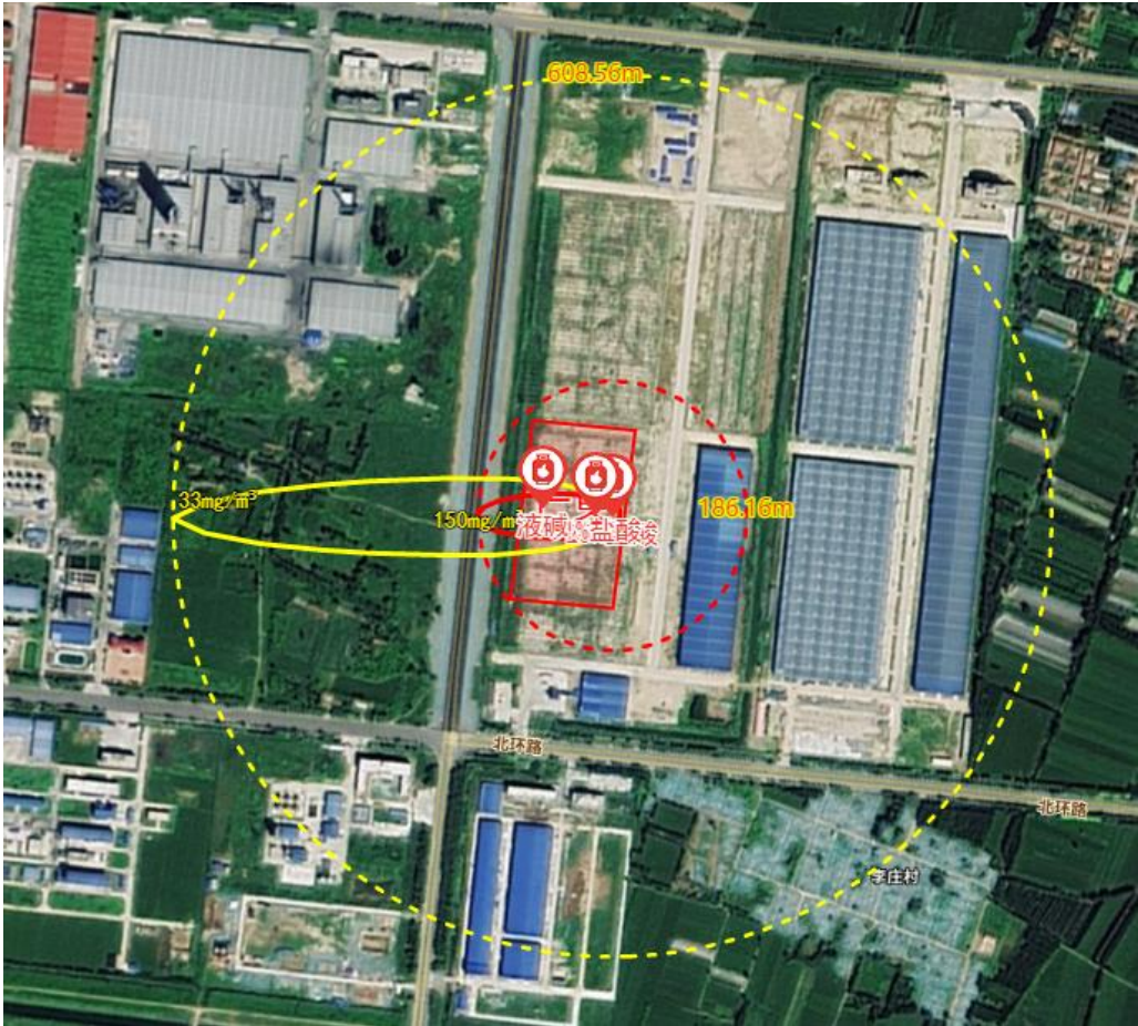
图 5.5-3 25%盐酸储罐泄漏液池蒸发扩散不同阈值的最大影响范围
