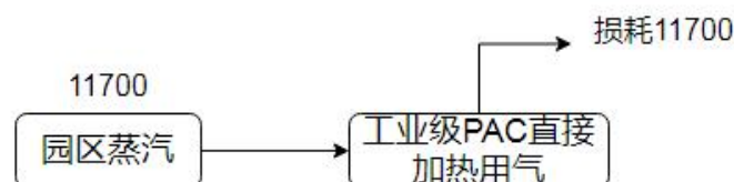
图 2.4-3：项目蒸汽平衡图（t/a）
