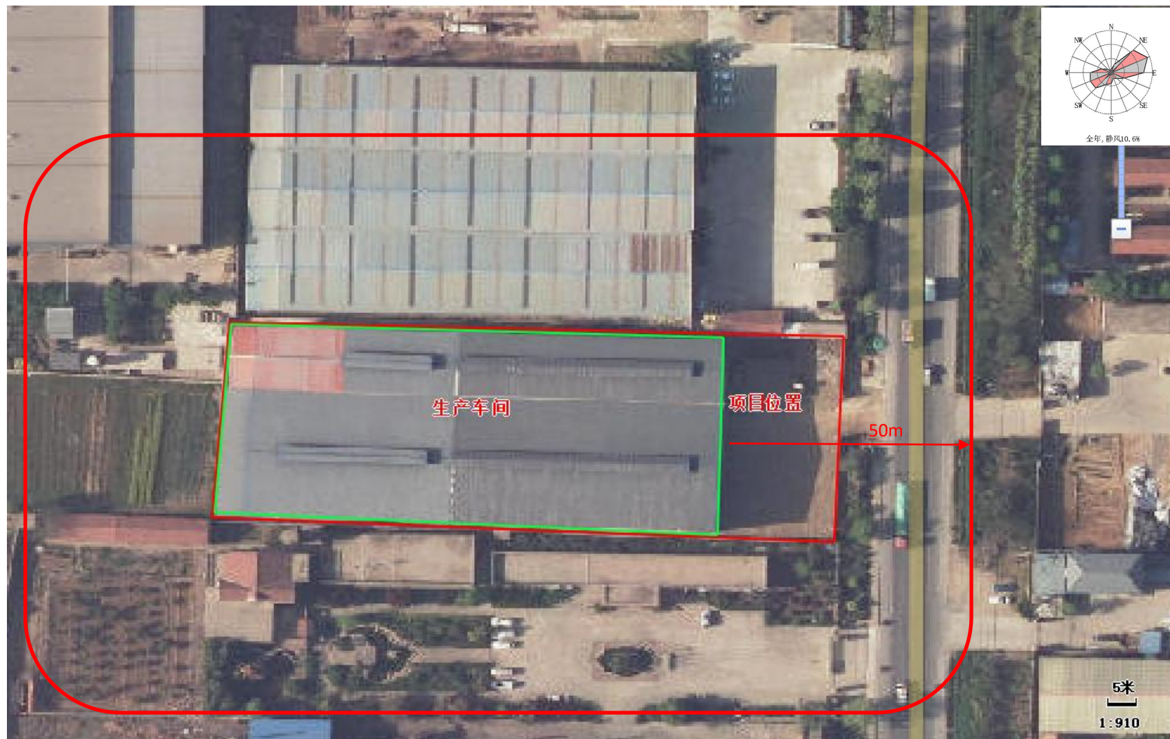
附图 4 卫生距离防护包络线图
